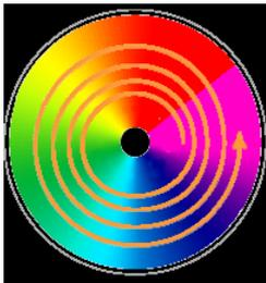
Pour augmenter la capacité de stockage d'un CD, il suffit d'allonger la piste. Il faut resserrer la spirale de la piste donc diminuer la largeur des creux et des plats. Le faisceau laser doit être le plus fin possible pour ne pas intercepter deux lignes contigües de creux et de plats. Pour un spot circulaire, le diamètre  $d$  du faisceau laser de longueur d'onde  $\lambda$  et d'ouverture numérique  $NA$  est:
